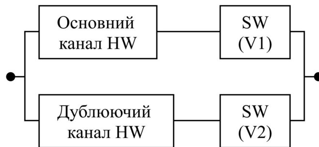
Рис. 4.22 Структурна схема надійності дубльованого двухверсійного ПТК S^{P_{22}}
