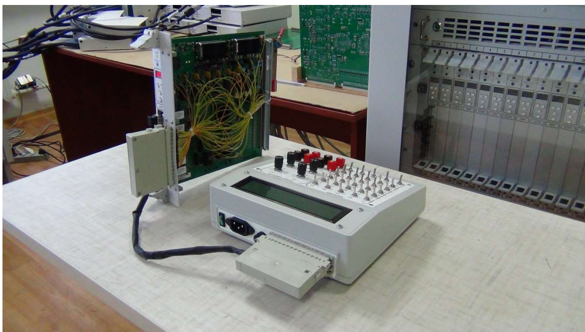
Рис 6.21 Модуль DIM з внесеними НВ дефектами
