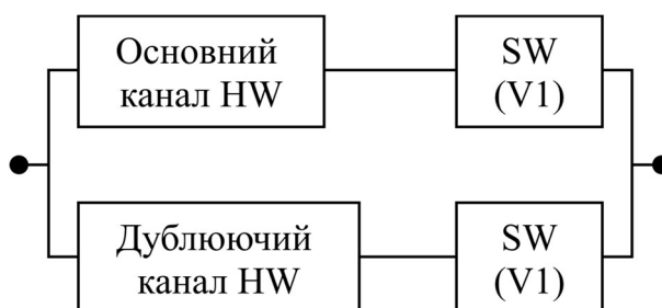
Рис. 4.19 Структурна схема надійності дубльованого одноверсійного ПТК S^{p_{21}} із засобами реконфігурування каналів.
