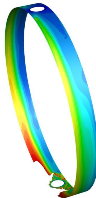
Рис. 6. Розподіл товщини плівки масла (мм)
