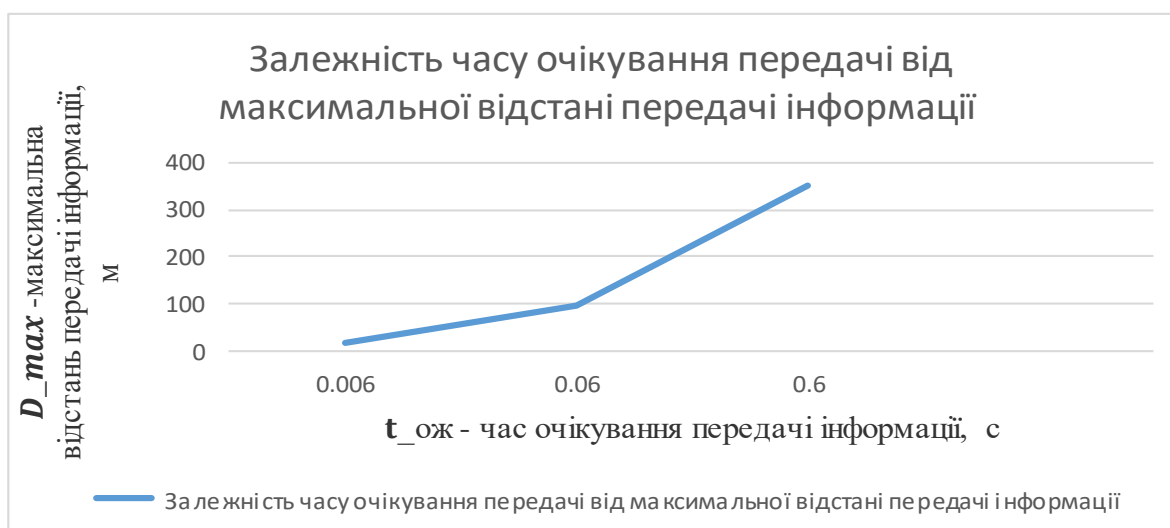
Рисунок 2 – Залежність часу очікування передачі від максимальної відстані передачі інформації
