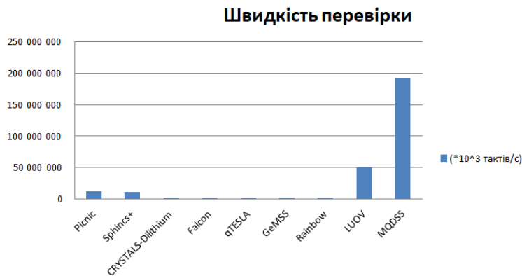
Рисунок 2 – Порівняння швидкості перевірки підпису для претендентів на пост-квантовий ЕП
