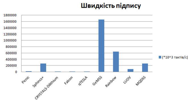
Рисунок 1 – Порівняння швидкості підпису для претендентів на пост-квантовий ЕП
